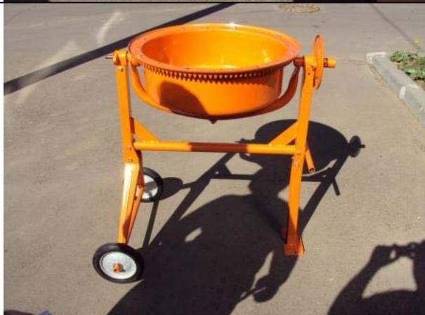
Далее устанавливаем штурвал большого диаметра. И крепим лопасти к днищу бака.
