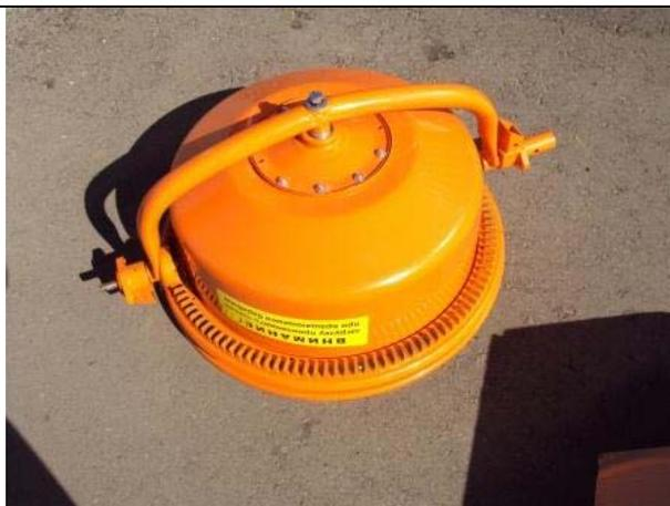
Далее на опору устанавливается нижняя часть бака. Фиксируется болтами.
