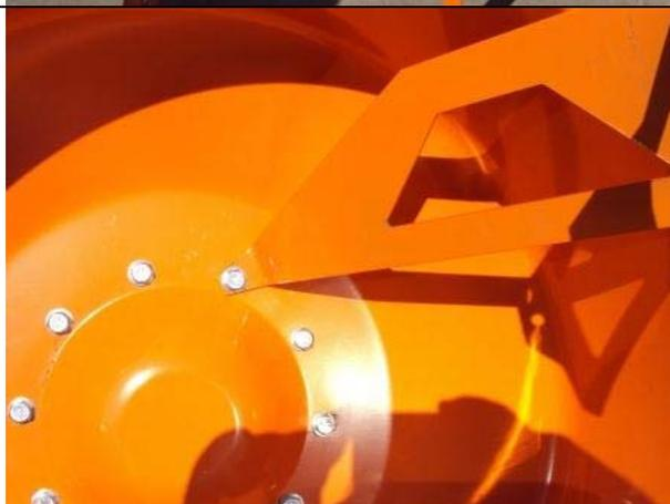
**НА ЗАМЕТКУ!** Резиновую прокладку надеваем на болты, установленные в верхнюю часть бака бетономешалки.
