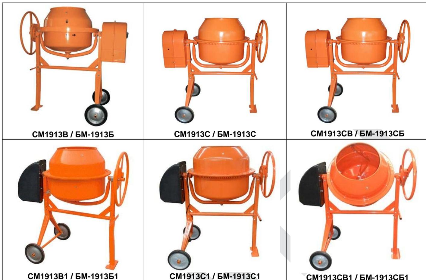
**ПРЕИМУЩЕСТВА:** Асинхронный электродвигатель предназначен для интенсивной работы с большими нагрузками. Бак выполнен из прочного металла: толщина нижней части составляет 2 мм, верхней - 1.5 мм. Высокая частота вращения бака - 30 оборотов в минуту, позволяет качественно смешать раствор. Крепкая и устойчивая рама; Прочные толстые лопасти (2мм); Удобный механизм наклона барабана; Закрытый электродвигатель. Болтовое соединение обеспечивает надежность конструкции.
