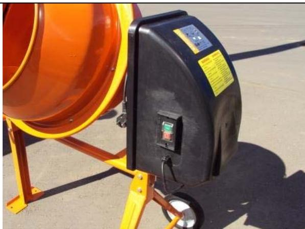
Удобные большие герметичные кнопки управления бетономешалкой.
