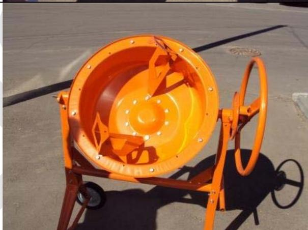
**НА ЗАМЕТКУ!** Лопасти крепим узкой частью к днищу, а широкой к верхней части бака бетономешалки.
