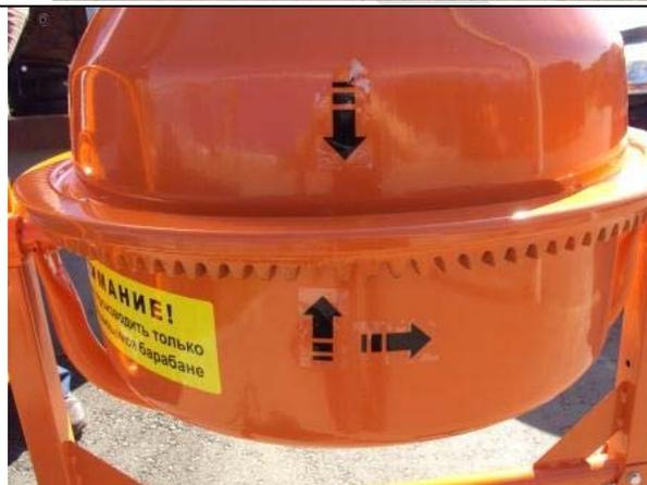
**ВАЖНО!** Загрузка перемешиваемых компонентов производится только тогда, когда бетономешалка работает, т. е. крутится барабан.
