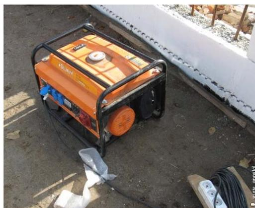
**ПРИМЕР:** Самая мощная и самая высокопроизводительная бетономешалка с объемом барабана 200 литров потребляет 750 Ватт. Следовательно, чтобы ее подключить к генератору, мощность бензогенератора должна составлять от 1 500 Вт до 2 250 Вт. Подойдут все генераторы Sturm / Энергомаш, кроме моделей PG8708/ЭГ-87080, PG8712/ЭГ-87120.
