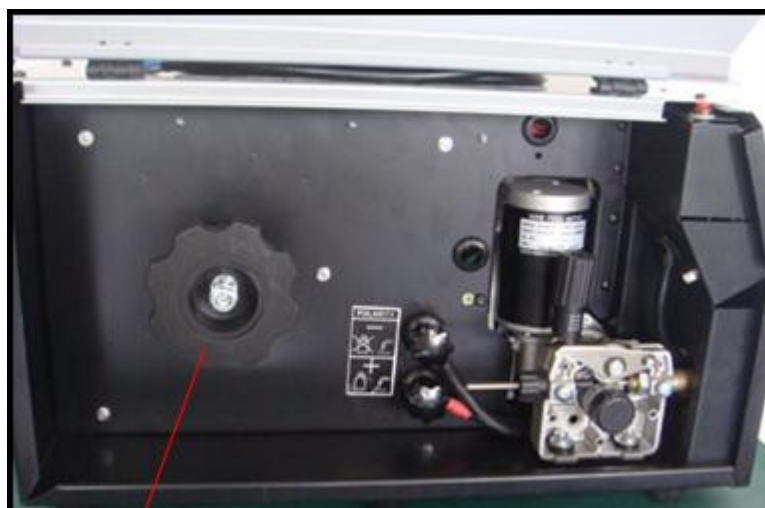
Место установки катушки со сварочной проволокой.
