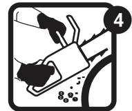
Малюнки 4: Правильне положення рук на бензопилці при роботі з пилою.
