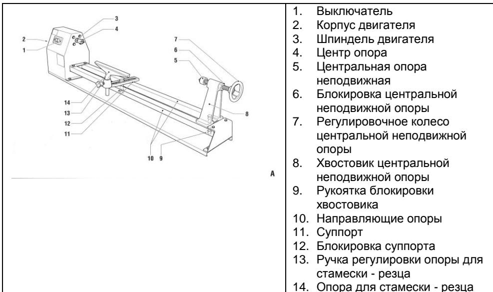
**Закрепление заготовки (Рисунки А и D)**
