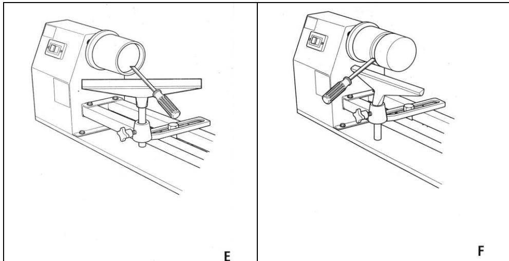
**Фиксация заготовки с использованием регулировочной плиты
