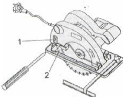
Регулировка расклинивающего ножа.
