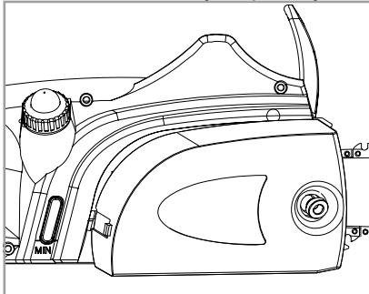
Используя гаечный ключ, закрутите натяжной винт таким образом, чтобы зазор между цепью и шиной составил приблизительно 2 мм.
