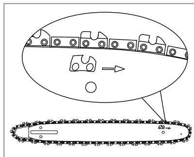
Совместите пильную шину/цепь со стопорным штифтом и натяжным винтом. Проверьте надежность сцепления шины/цепи с ведущим колесом (13).
