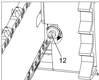
Установите боковую крышку и слегка закрутите стопорную гайку.
