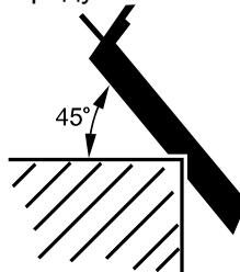
Вы можете снять фаску под углом в 45 градусов при помощи V-образной канавки, расположенной на подошве (см. рисунок выше).
