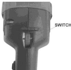
Установите требуемую скорость вращения диска с помощью электронного регулятора(switch), см рис 3. Диапазон скоростей от 600 об/мин(положение «1»), до 3000 об/мин (положение «6»)
