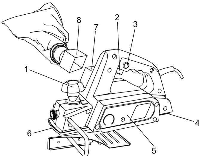
1. Рукоятка регулировки глубины обработки
