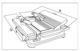
Отрегулируйте рукоятки фиксации направляющей (Q). Для фиксации направляющей (A) в крайней части стола закрутите фиксирующие рукоятки (Q)
