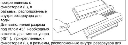
воды. Установите кусок плитки (лицевой стороной вниз) на крышку поддона (D), а затем начните движение обрабатываемой плитки в сторону режущего диска (Н).
