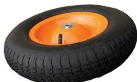
Подходит к тачке 3011-02-WB150 и к тачкам других марок соответственно допустимым параметрам: подшипник 16мм; внутренний диаметр колеса 205мм; ширина колеса 85мм
